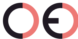
Falsche CE-Kennzeichnung (zu großer Zwischenraum)
