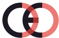
Falsche CE-Kennzeichnung (zu dicht)
